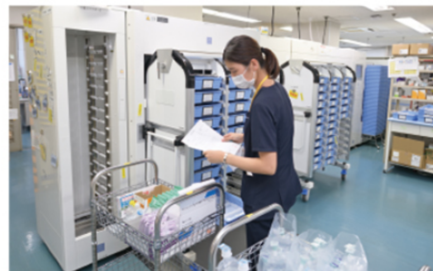
処方オーダリングと連動する注射薬自動抽出システム(アンプルピッカー)が稼働
